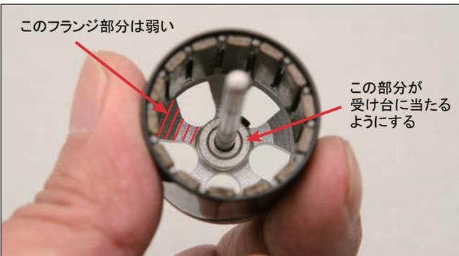
(3) アウターローターは柔らかいアルミ合金製ですので僅かな力で変形する可能性があります。ごく僅かな歪みが生じてモーターを回転させた時にブレが出ますので、作業の際は必ず受け台を使って下さい。このとき、後側ハウジングのシャフトを保持している平らな部分に堅木の棒があたるようにします。(受け台は作業台の上に固定するか、助手のかたにしっかり支えてもらってください)
