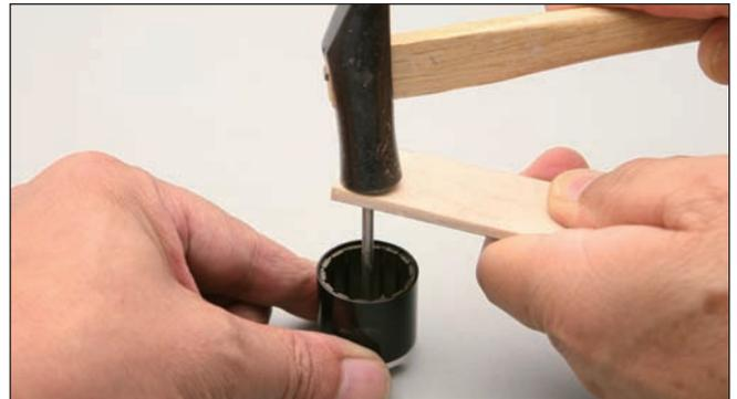
(6) 新しいシャフトを入れる時は、回り止めの切り欠きの向きに注意して内側から垂直に打ち込みます。シャフトを傷つけないよう必ず当て木をし、またフランジ部分に変形しないよう様に、大きな力で一度に打ち込むのではなくコツコツと無理をせず慎重に叩き込んでください。
