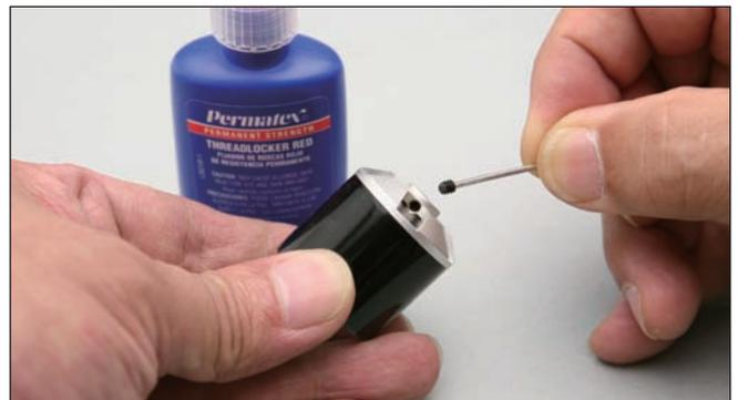
(7) ネジロックをつけてイモネジを締め込みます。出来上がったあと元通りに組み立て、手で回して異常がなければ試運転してください。試運転の際はゆっくり様子を見ながら回転を上げてください。
