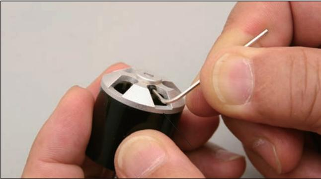
(1) 交換シャフトに付属の六角レンチを使ってハウジング後端にあるイモネジを外す。
